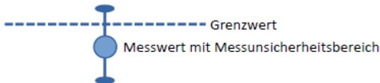
**Konformitätsaussage:** Der Messwert liegt unterhalb des Grenzwertes, er gilt als **konform**. Da die Messunsicherheit allerdings den Grenzwert einschließt, kann die Einhaltung nicht mit hinreichender Sicherheit festgestellt werden. I. d. R. wird in diesem Fall bei relevanten Fragestellungen eine Wiederholung der Untersuchung empfohlen.
